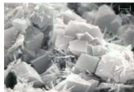
ZEM70 Zeolite Chabasite presenta una struttura cristallina di tipo pseudocubico. La superficie risulta essere più scabrosa rispetto alla struttura delle altre zeoliti e quindi idonea alla repellenza degli insetti.
